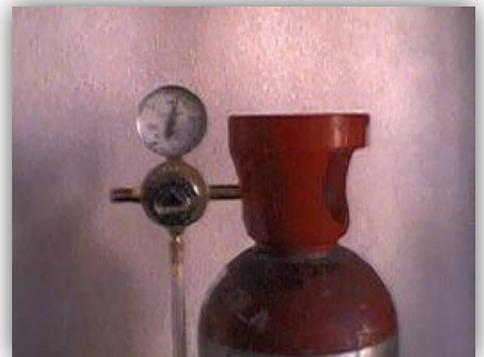
Para poder trabajar con seguridad **SIEMPRE SE DEBE DISPONER DE UN REGULADOR DE PRESION ENTRE EL TUBO Y EL TANQUE A PRESURIZAR.**
