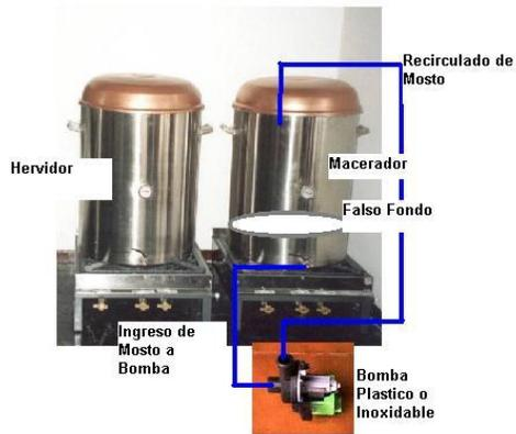
Llenado de Hervidor y lavado de granos, si dispone de dos bombas es el esquema mostrado, si dispone de una sola bomba el paso de agua del tanque de agua (balde 20 litros) a macerador para lavado se realiza con jarra a mano. (Figura 6)
